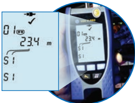
Testowanie kabli koncentrycznych
