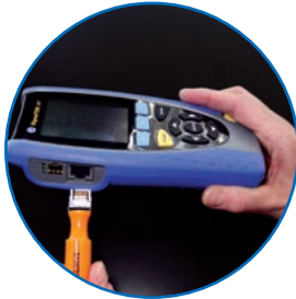
Nie wymaga kalibracji oraz posiada wymienne gniazda RJ45
