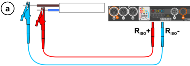
Pomiar z użyciem sond.
