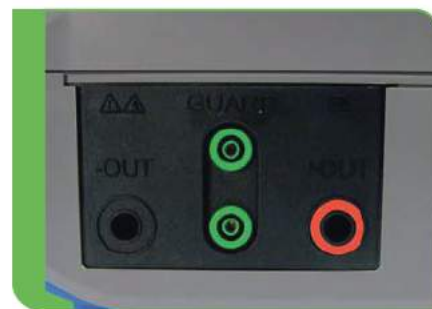
Zacisk GUARD eliminujący wpływ rezystancji powierzchniowej
