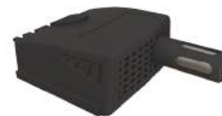
Moduł warunków klimatycznych (MCC) Zakresy pomiarowe od 0 do +50°C, od 800 do 1100 hPa oraz od 5 do 95%RH
