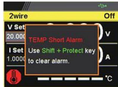
Czerwony: Alarm wyłączenia zasilania spowodowany przekroczeniem ustalonej temperatury
