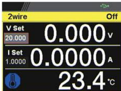
Niebieski: Pomiar temperatury włączony, brak podłączonej termopary GTL-205A
