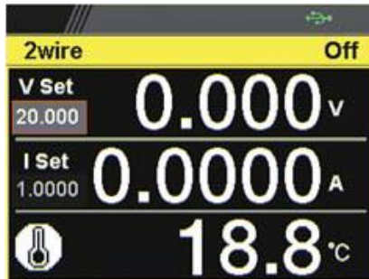
Biały: Pomiar temperatury jest włączony, termopara GTL-205A jest podłączona
