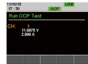
Wynik: Końcowy stan wyjścia testowanego urządzenia przed zadziałaniem OCP
