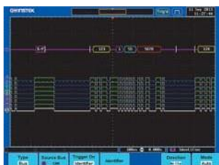
Dekodowanie i wyzwalanie magistrali CAN
