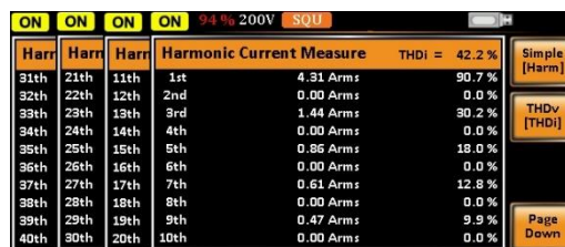
Pomiar harmonicznych prądu
