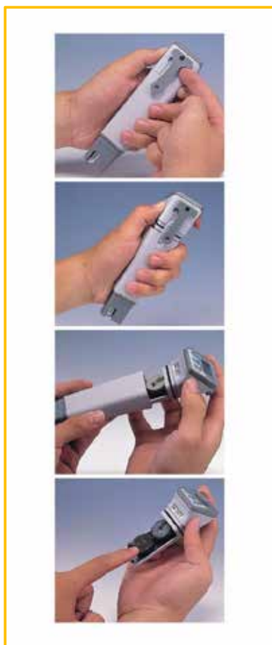
Przykład wymiany baterii lub/i elektrody
